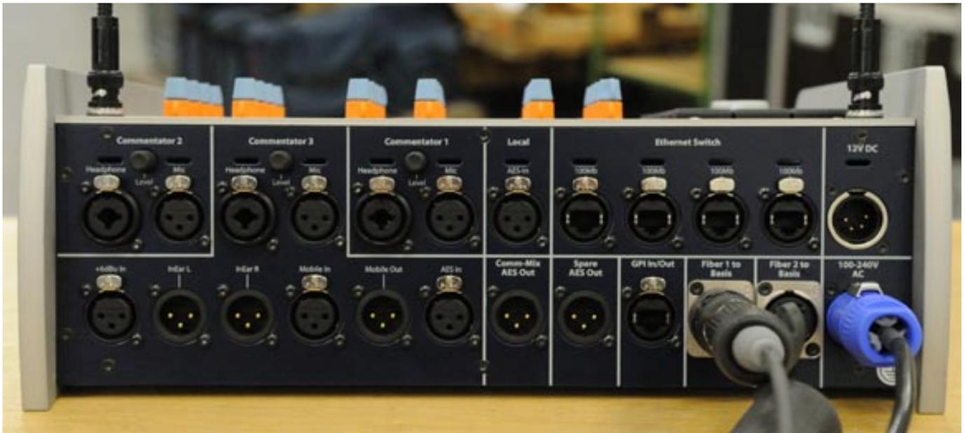
Auf der Rückseite der Kommentatoreneinheit befinden sich über den Audio-Buchsen drei Regler, mit denen die Signale der drei Kommentatorenkanäle zusammengemischt werden können und der Mischausgang kann dann z. B. auch ein Audiocodec geführt werden. Durch den Multiuser-Eingang (dritter Kommentator) befinden sich hier mehr Anschlüsse auf der Rückseite als in den Kommentatoreneinheiten in den Sprechkabinen.
